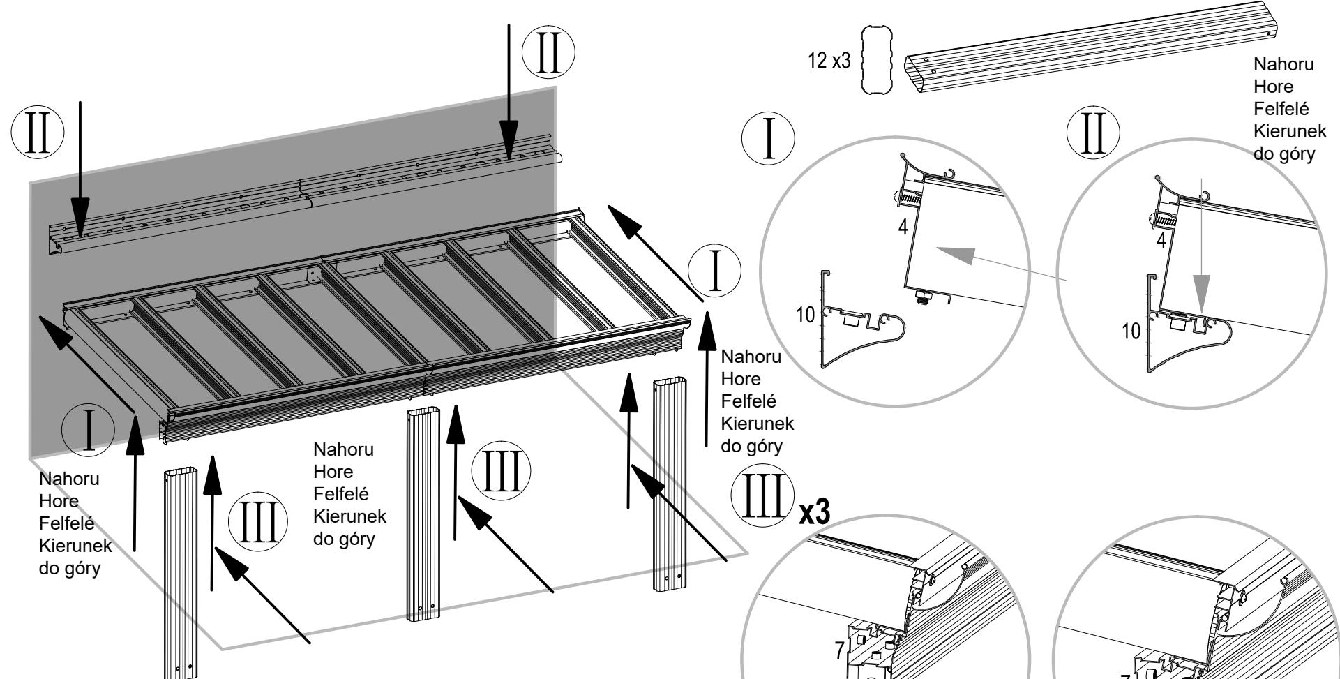
Spáru mezi profilem č. 4 a fasádou doporučujeme dotesnit vhodným tmelem (např. neutrální silikon).
