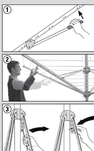
**Öffnen:** Betätigungshebel anheben, die Wäschespinne öffnet sich und wird von der eingebauten Gasfeder langsam gespannt. Der Betätigungshebel bleibt dabei kurz vor dem Tragarm stehen. Bei tiefen Temperaturen werden durch leichten Druck auf den Betätigungshebel nach oben (1) die Leinen fertig gespannt.
